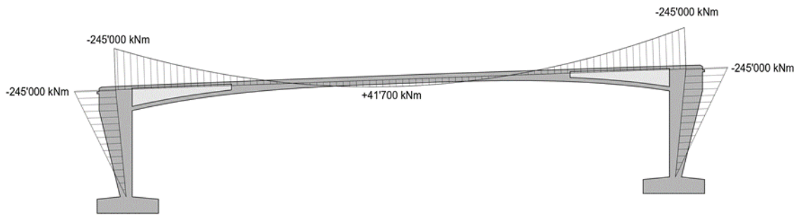
Figura 18 Ponte Bondasca: momento flettente a dimensionamento M_{y,d} incl. precarichi. Forza assiale a dimensionamento N_d = - 18'700 \text{ kN}
